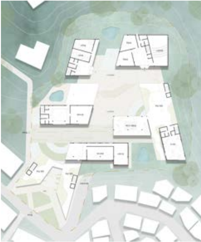
그림11. 복합 노인여가복지시설 3층 평면도
